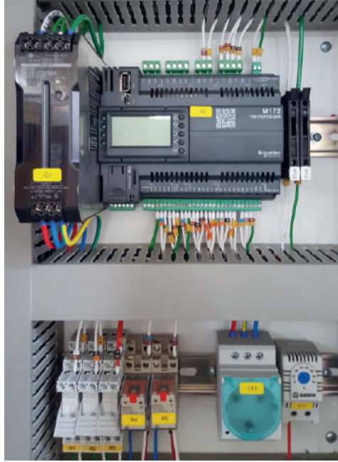
THNS serisi santrallerde kullanılan programlanabilir kontrol paneli
